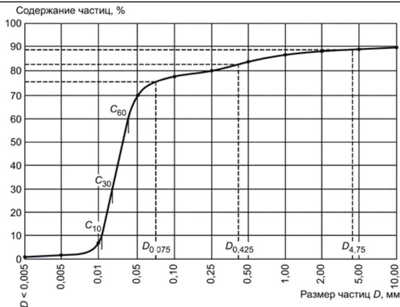
Рисунок Е.2 - Кумулятивная кривая гранулометрического состава
